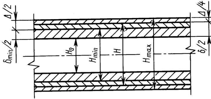
$H_0$  — обдирочный размер заготовки или номинальный размер детали;
